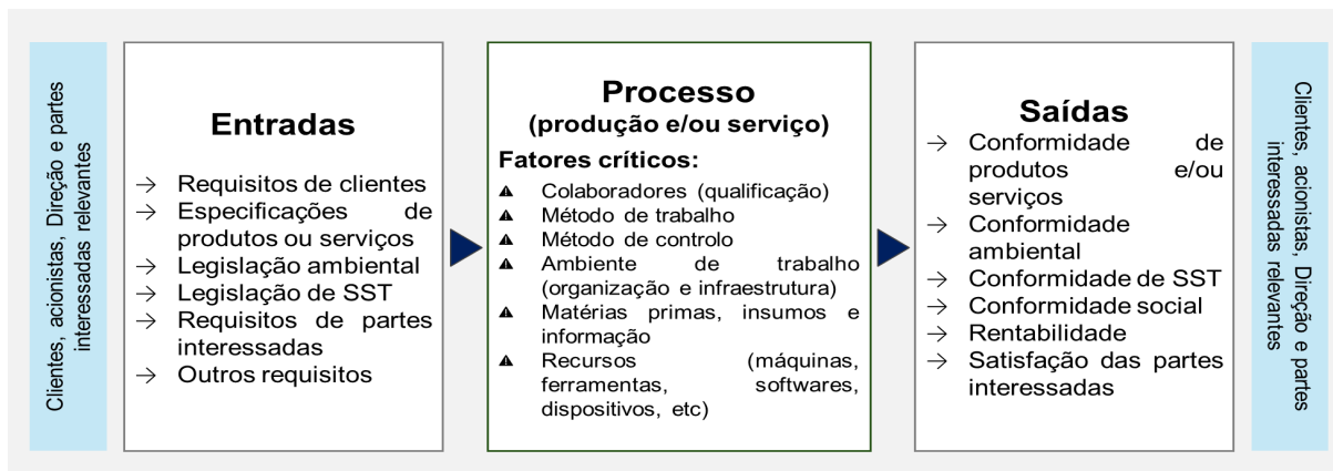
Figura 5. Representação esquemática dos elementos de um processo no âmbito de um SGI.
