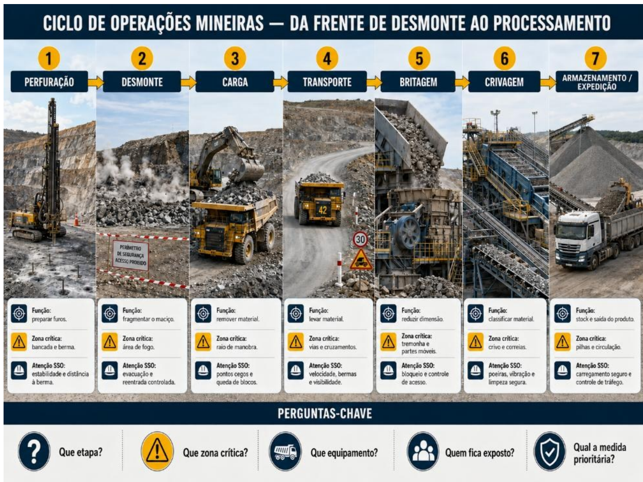
Figura 3.1 — Ciclo de operações mineiras: da frente de desmonte ao processamento dos minérios
