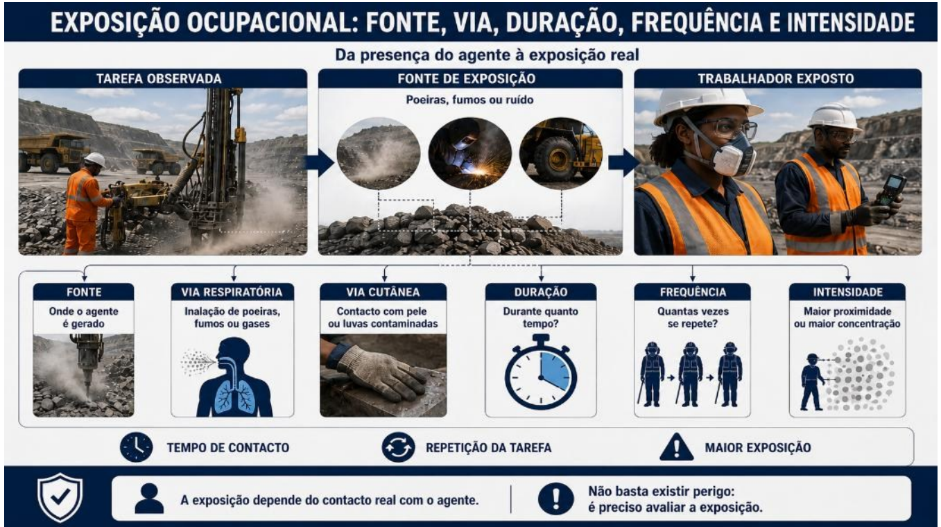
Figura 2.2 — Exposição ocupacional: fonte, via, duração, frequência e intensidade
