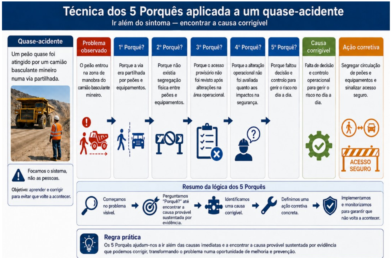
Figura 6.4 — Técnica dos 5 Porquês aplicada a um quase-acidente
