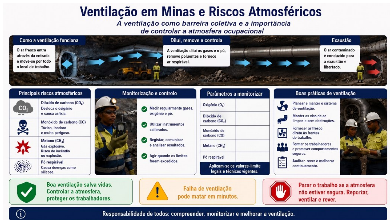
Figura 2.6 — Ventilação mineira e perigos atmosféricos
