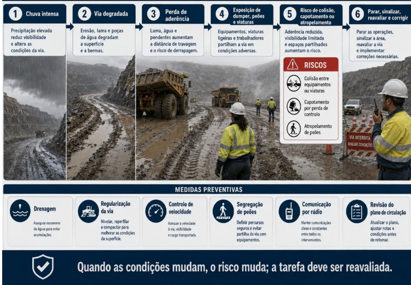
Figura 1.13 – Caso integrador: risco dinâmico numa via degradada após chuva
