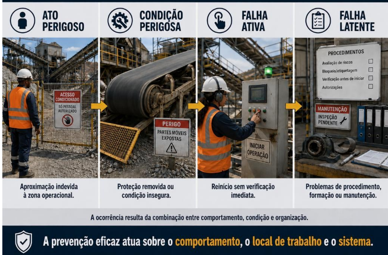
Figura 1.4 – Atos perigosos, condições perigosas, falhas ativas e falhas latentes
