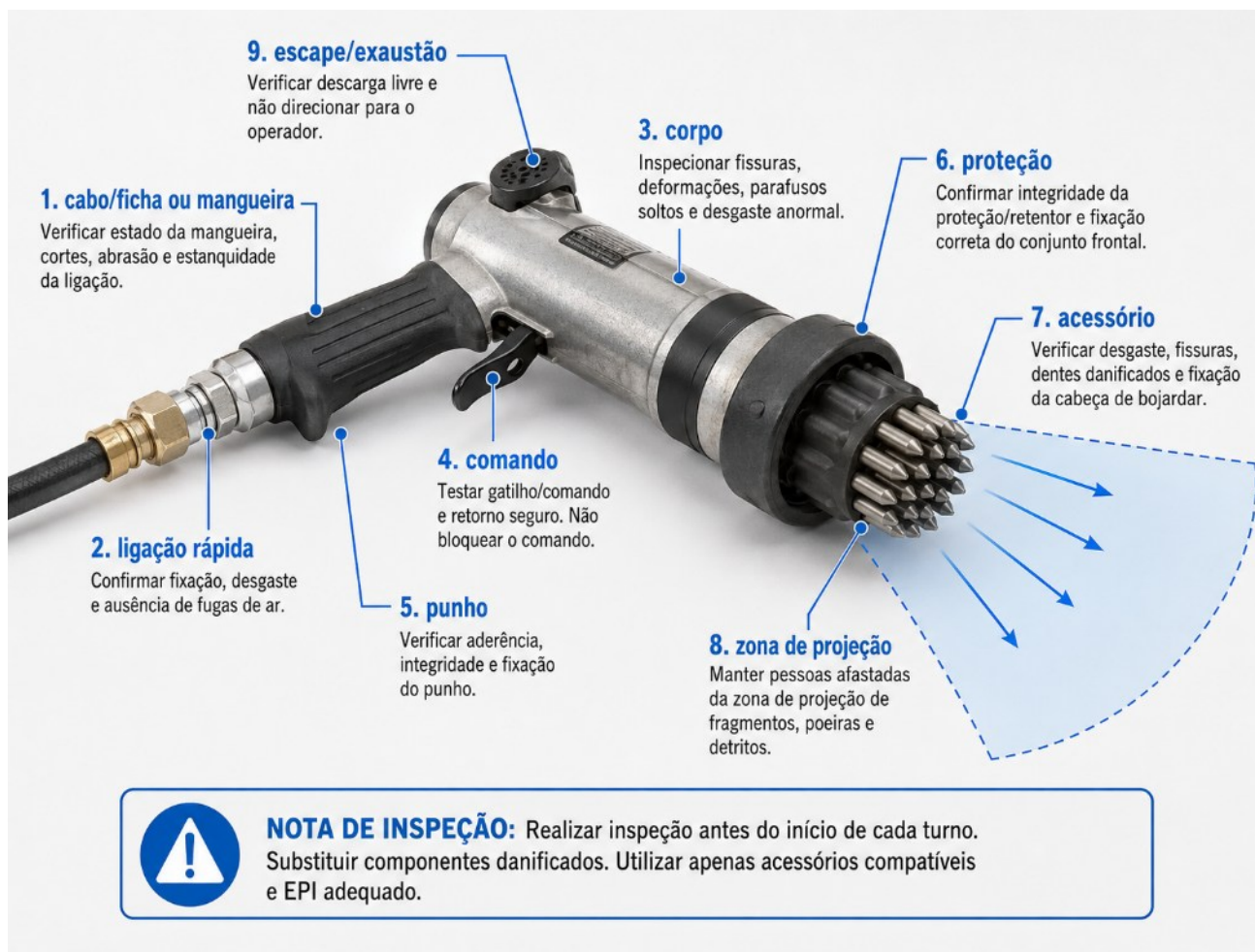
Figura 4.4 — Pontos de inspeção de um martelo pneumático de bojardar
