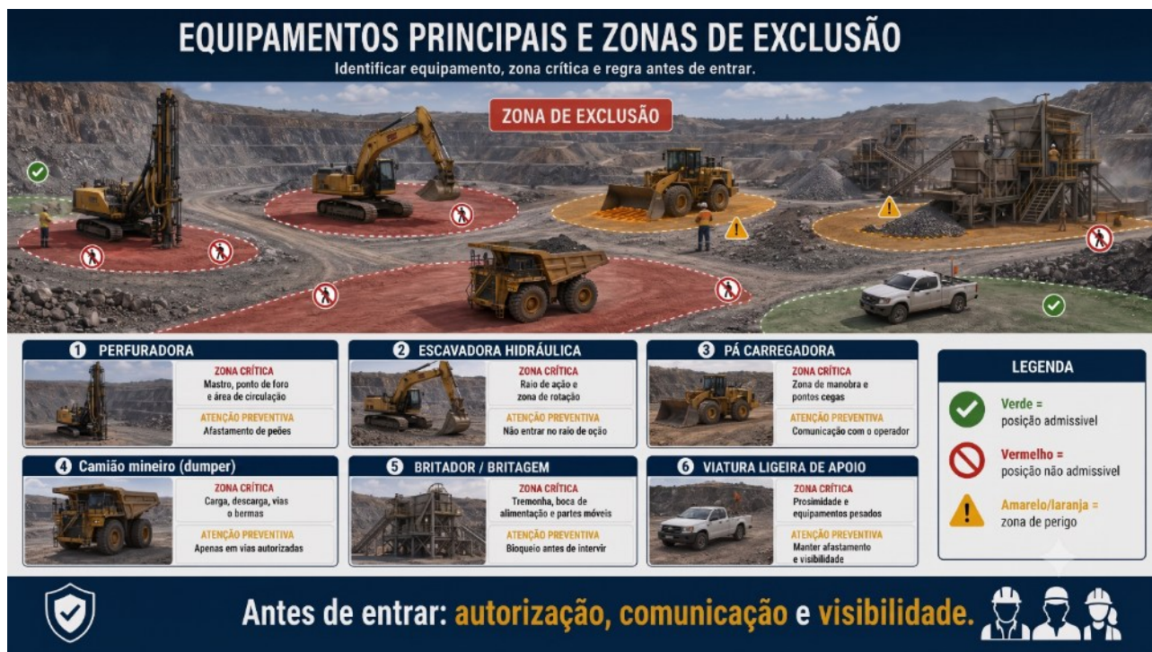
Figura 3.3 — Equipamentos principais e zonas de exclusão
