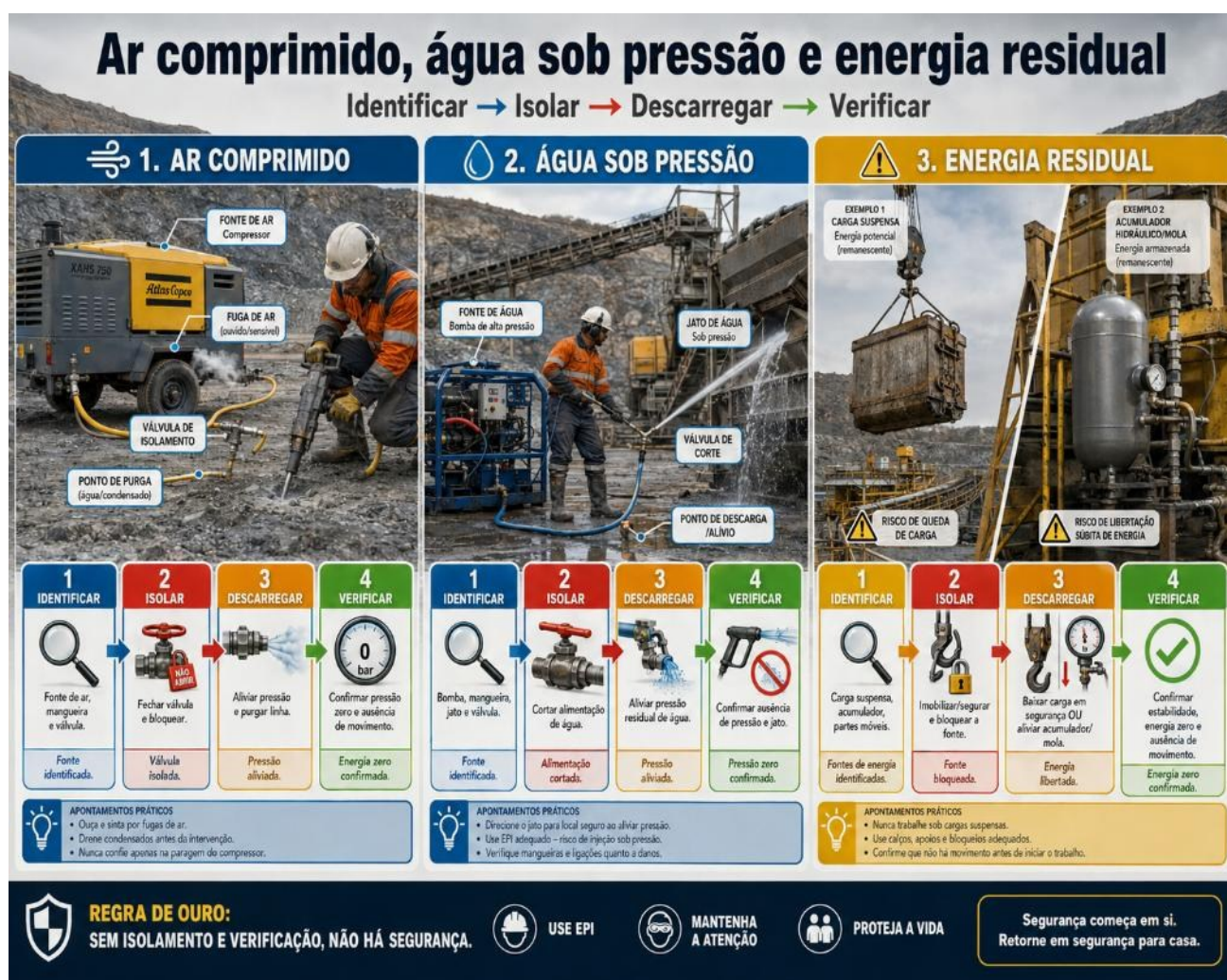
Figura 4.8 — Ar comprimido, água sob pressão e energia residual
