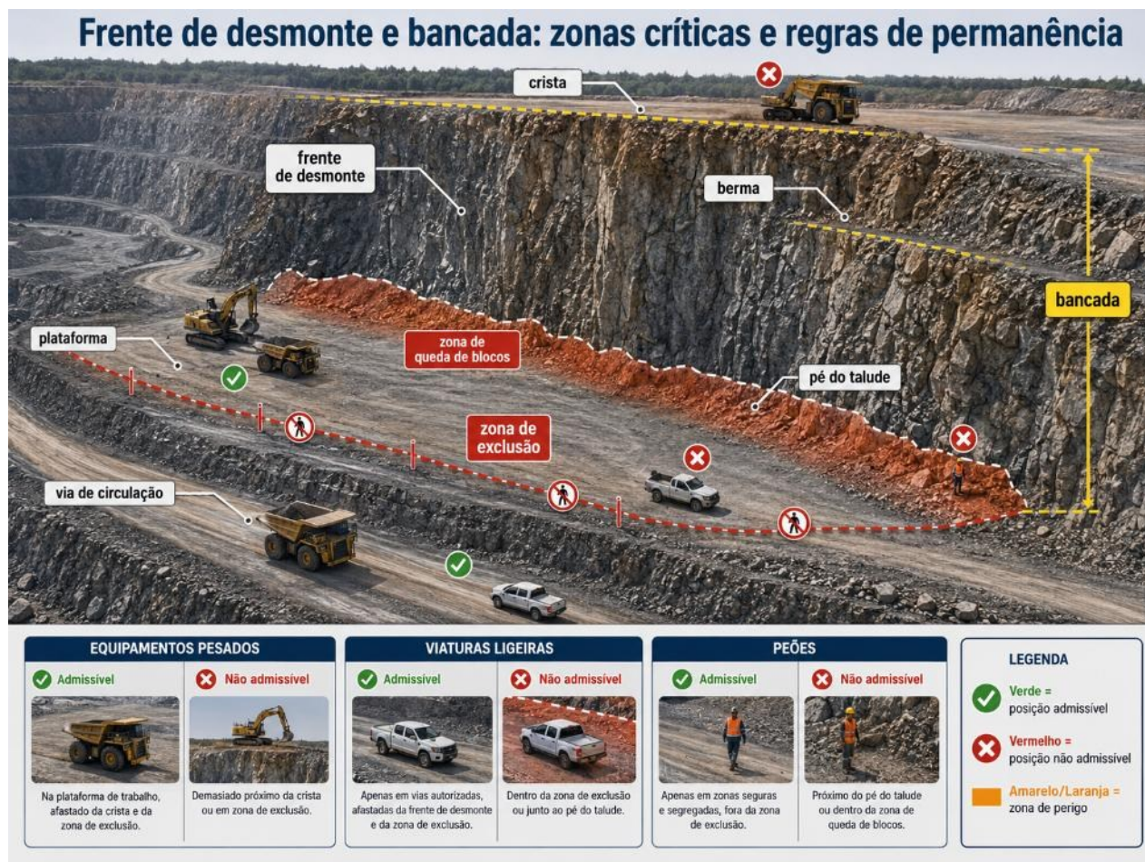
Figura 3.2 — Frente de desmonte e bancada: zonas críticas e regras de permanência
