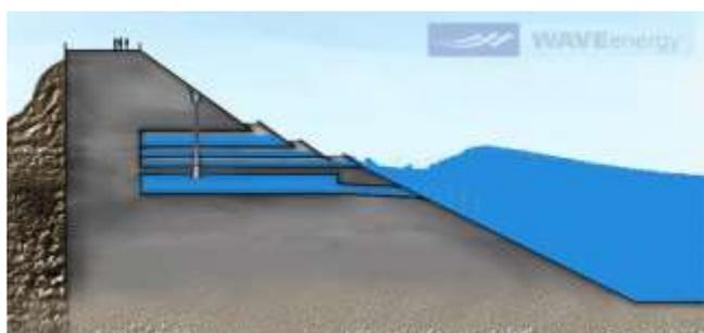
Figura 2. Esquema representativo do funcionamento dos dispositivos por galgamento.
