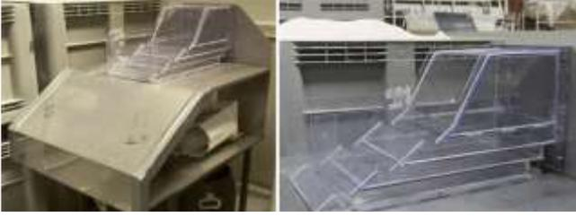
Figura 7. Fotografias do modelo construído: à esquerda a estrutura completa; à direita o pormenor do dispositivo SSG.
