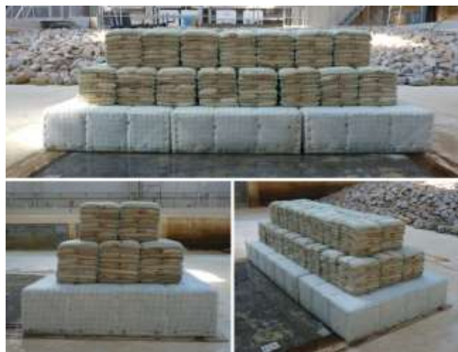
Figura 1. Modelo do quebramar destacado construído (vista frontal, vista lateral e vista oblíqua, respetivamente em cima, em baixo à esquerda e em baixo à direita).
