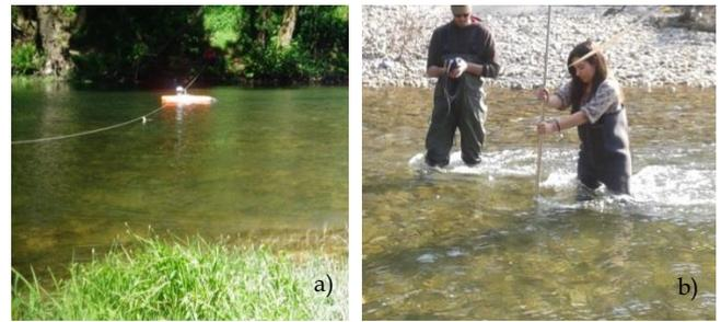
Figura 2. a) Medição de caudais com o OTT MF Pro, no Rio Vouga; b) Medição de caudais no Rio Vouga, utilizando o River RAY.
