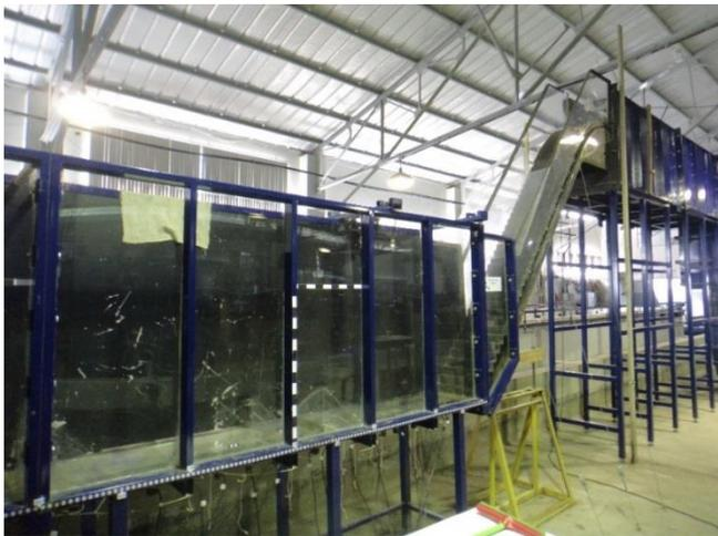
Figura 8. Canal hidráulico.
