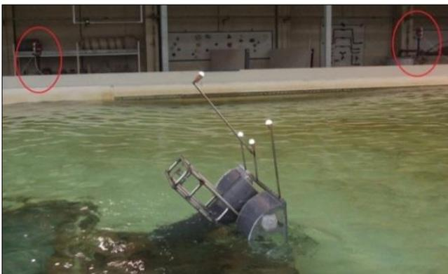
Figura 5. Posicionamento das câmaras de infravermelhos em relação ao CECO e marcas refletoras nele instaladas.
