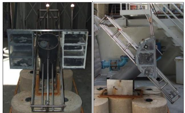
Figura 4. Vista frontal (à esquerda) e lateral (à direita) do modelo físico do dispositivo CECO.
