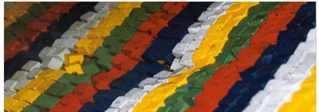
Figura 2. Efeito da aplicação de enrocamento de reduzida dimensão na subcamada.
