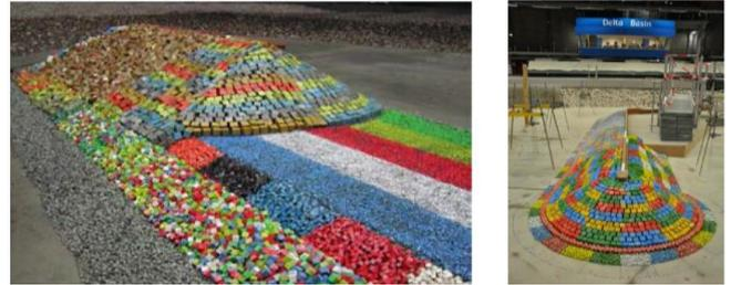
Figura 9. Ensaios em modelo físico reduzido das cabeças provisórias em mantos de camada única em Cubos em Punta Langosteira (esquerda) e Cubos em camada única na cabeça do quebra-mar de Sal Rei na Ilha da Boa Vista (direita).
