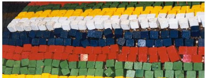
Figura 3. Vista da abertura/falha na transição entre o talude e o coroamento.
