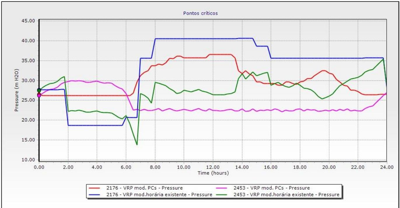
Figura 2. Pressão nos PC da rede de distribuição da Preciosa-Mar para as modulações pelos dois PC e horária existente.
