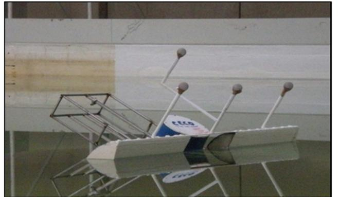
Figura 6. Disposição das marcas refletoras do sistema Qualisys no dispositivo CECO.
