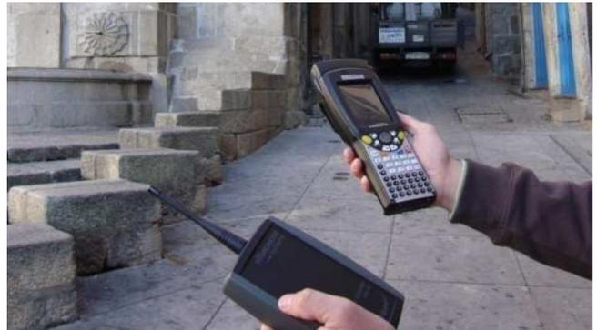
Figura 3. Exemplo de terminal recetor de rádio e terminal portátil de leitura percorrendo a rua e recebendo as leituras.
