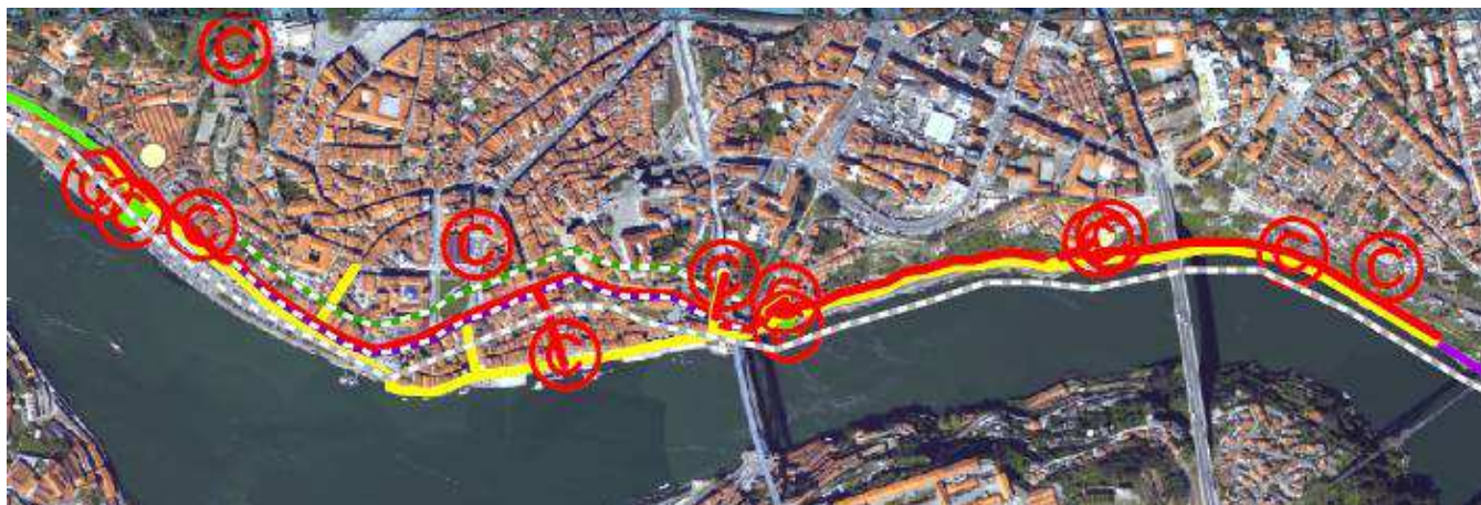
Figura 44. Interceptor Douro - Troço e órgãos a intervir.
