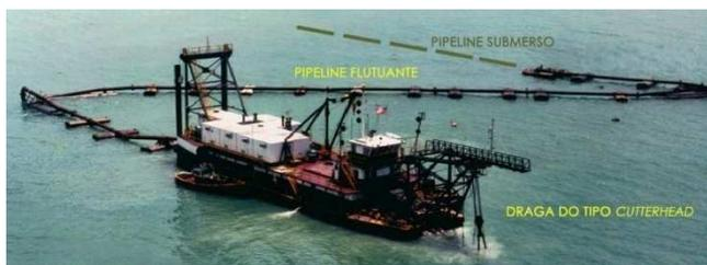
Figura 2. Dragagem ao largo de *Captiva Key*, no Sudoeste da Flórida, e transporte através de um *pipeline* (Encyclopedia of Coastal Science, adaptado).
