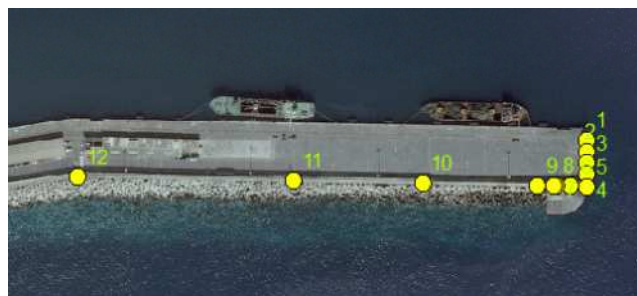
Figura 2. Distribuição espacial dos pontos de controlo pertencentes à rede de monitorização da estabilidade absoluta do quebramar.
