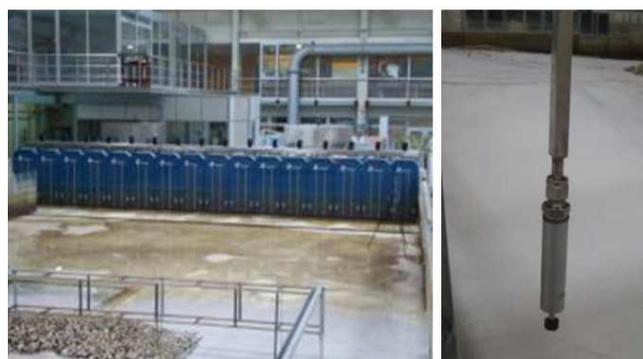
Figura 5. Batedores do sistema gerador de ondas e pormenor da ponteira sensível ao toque do medidor de fundos.
