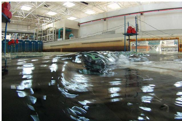
Figura 5. Vista do tubo na Série I / Ensaio 1, Teste 56 (CM=0.8m (Z.H.), H=1.5m, T=11s).
