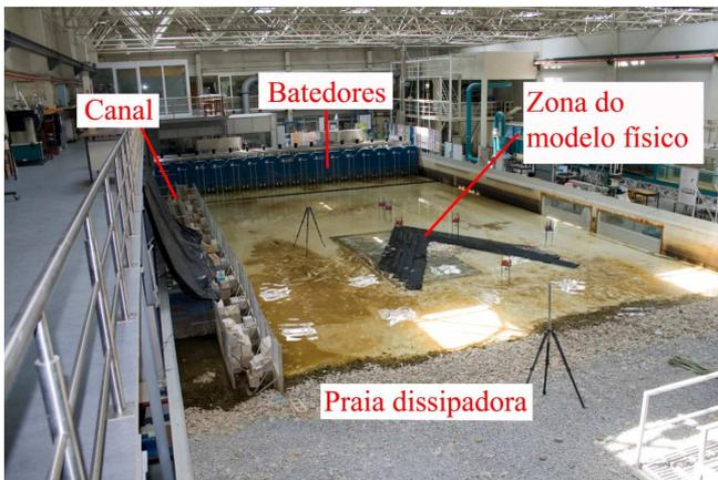
Figura 3. Tanque de ondas.
