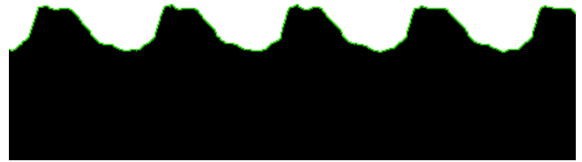
Figura 11. Resultado da análise Edge Time Stack para o alinhamento 3 do teste 702, após binarização da imagem (ampliação). Note-se o desaparecimento do pequeno pico de espuma no topo das cristas e a linha, a verde, que define o contorno da superfície livre.
