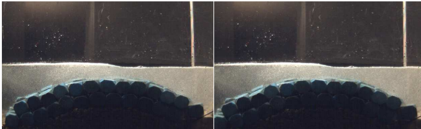
Figura 18. Imagem antes e após a correção das distorções da lente.
