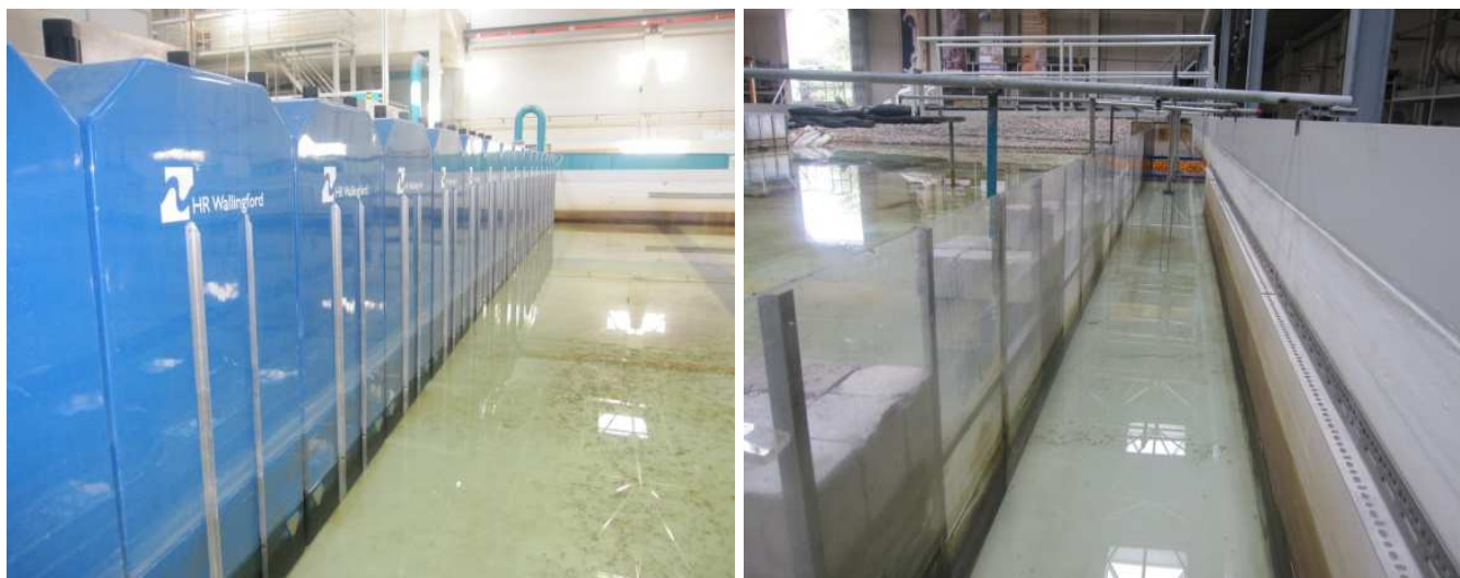
Figura 2. Sistema de geração de ondas (modelo HR Wallingford), e canal lateral.
