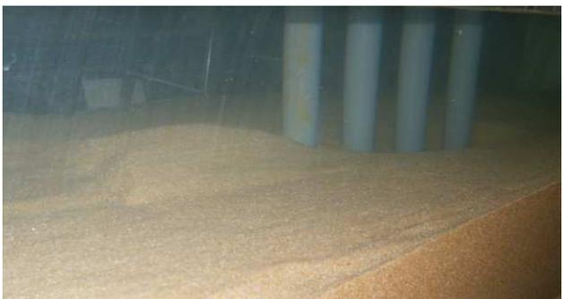
Figura 6. Duna criada a jusante da cavidade de erosão resultante do transporte sedimentar (foto de jusante para montante).
