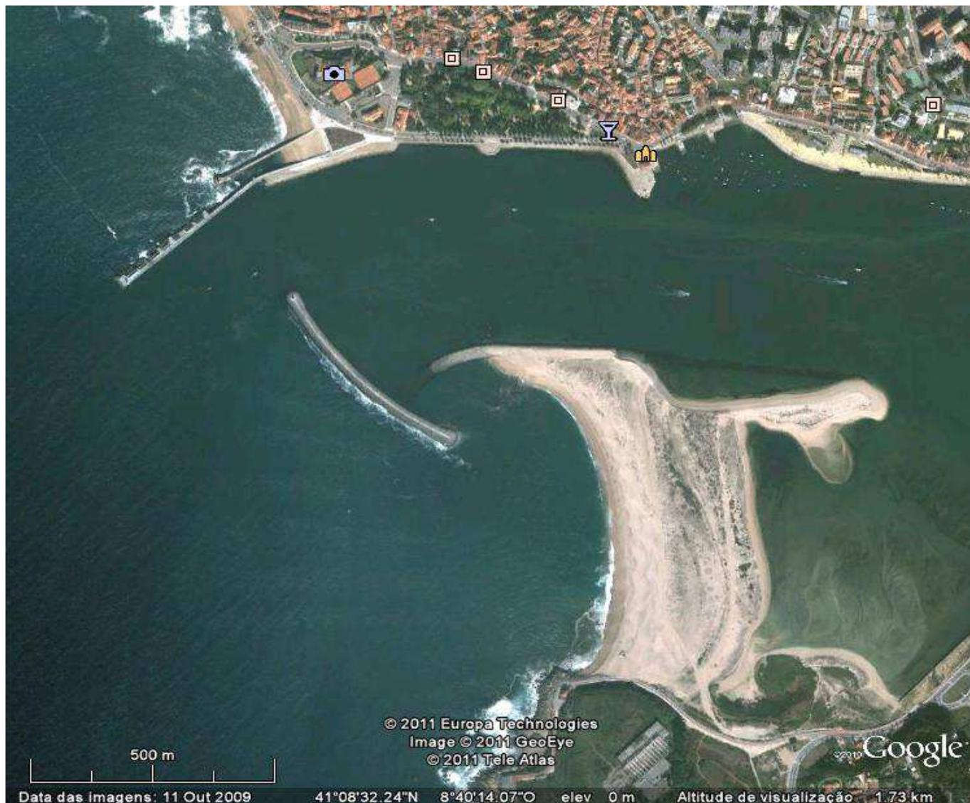
Figura 4. A embocadura do rio Douro em Outubro de 2009, com os molhes centenários de Felgueiras e Touro (margem direita), eng<sup>o</sup> Luís Gomes de Carvalho (na extremidade da restinga) e os novos quebramares na margem direita e na embocadura (quebramar destacado).
