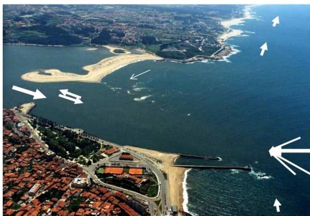
Figura 1. Um estuário caracterizado por um elevado hidrodinamismo associado aos caudais, marés e agitação marítima e à intensa interacção entre estes agentes físicos e as fronteiras sólidas naturais e artificiais.
