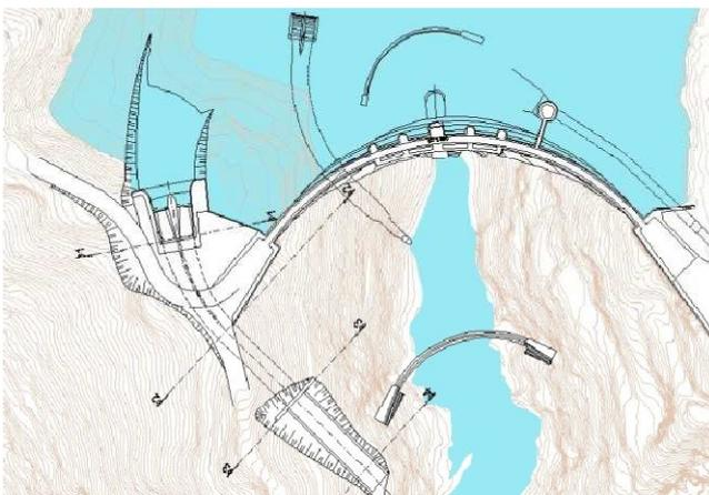
Figura 13. Planta da barragem de Salamonde. Novo descarregador de cheias, EDP - Gestão da Produção de Energia, S.A (2006a).
