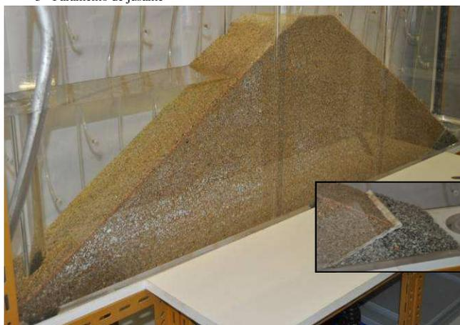
Figura 2. Geometria (mm) e modelo físico da barragem homogénea com dreno de pé de talude.
