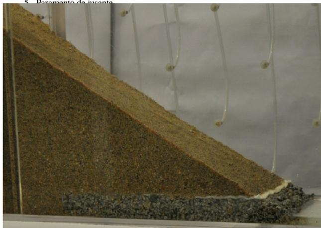
Figura 1. Geometria (em mm) e vista parcial do modelo físico da barragem homogénea com dreno horizontal.
