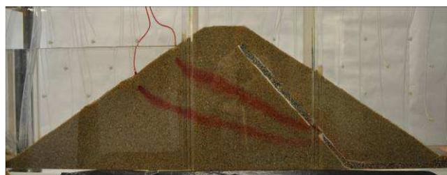
Figura 10. Trajectória do produto corante na barragem com dreno de chaminé.
