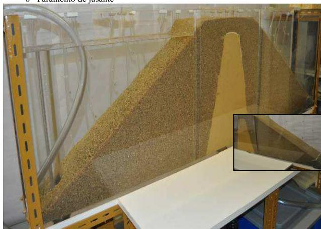
Figura 4. Geometria (mm) e modelo físico da barragem zonada.
