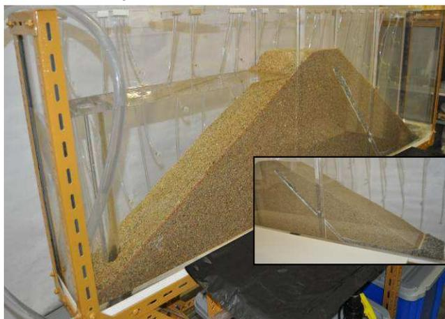
Figura 3. Geometria (mm) e modelo físico da barragem homogénea com dreno de chaminé.
