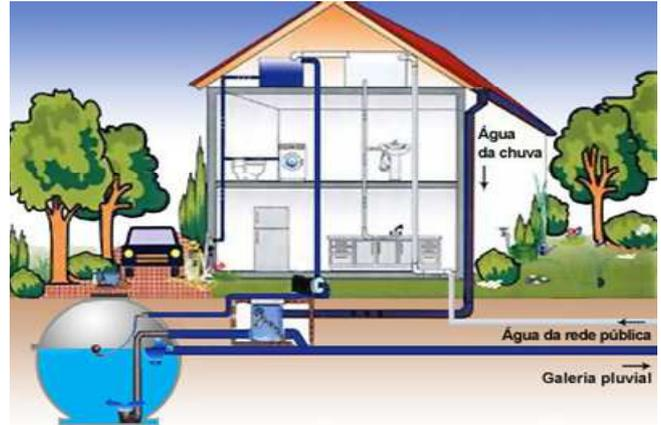
Figura 1. Esquema geral de um SAAP (www.bellacalha.com.br).
