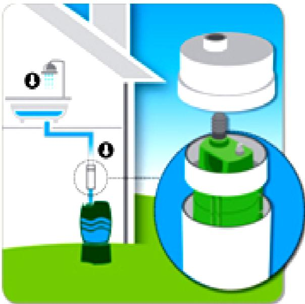
Figura 6. Exemplo de filtro para águas cinzentas.
