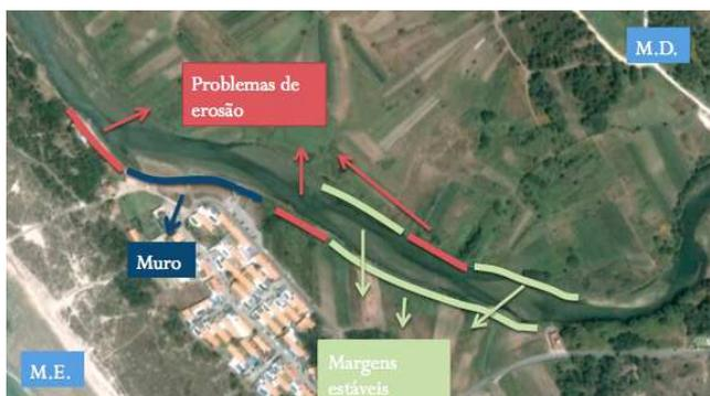
Figura 2. Troço estudado, com a identificação dos diferentes tipos de situações encontrados.
