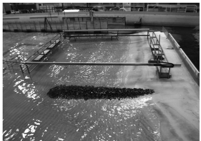
Figura 6. Modelo físico reduzido com fundos de areia em situação de erosão, durante a realização da série III de testes.
