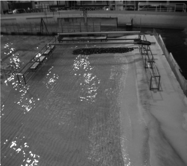
Figura 7. Modelo físico reduzido com fundos de areia em situação de erosão, durante a realização da série IV de testes.
