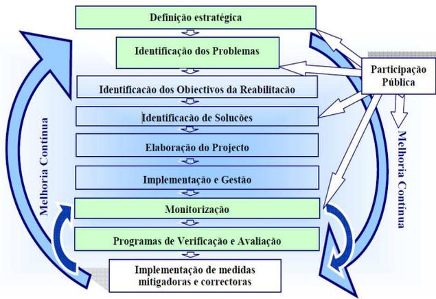
Figura 1. Esquema geral das etapas de processos de reabilitação (Teiga *et al.*, 2007).
