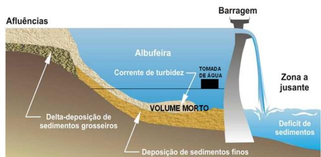
Figura 2. Padrão típico de deposição dos sedimentos nas albufeiras ([http://www.dha.lnec.pt/nre/english/projects/sedim\\_eng.html](http://www.dha.lnec.pt/nre/english/projects/sedim_eng.html)).
