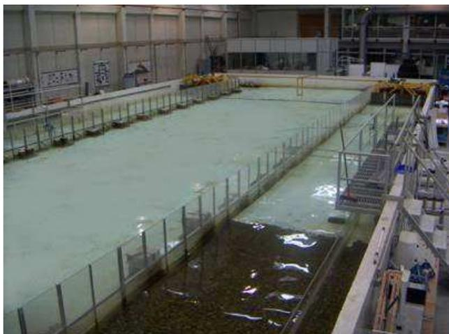
Figura 4. Vista geral do tanque de ondas do Laboratório de Hidráulica da FEUP.
