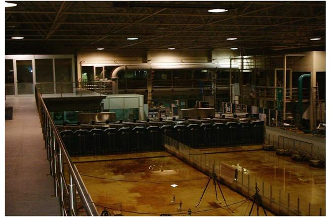
Figura 13. Tanque de ondas do Laboratório de Hidráulica da FEUP.
