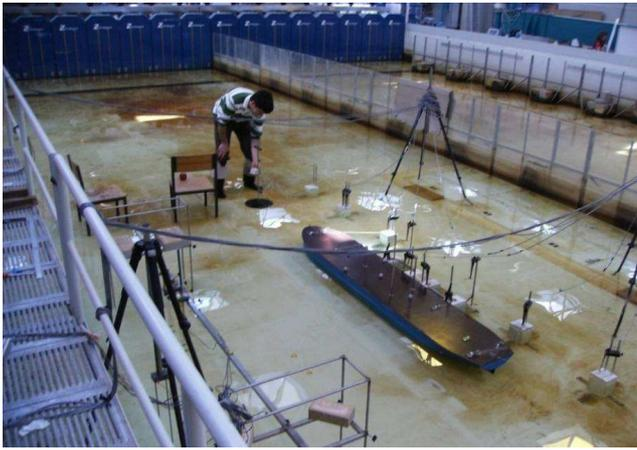
Figura 7. Determinação do período natural da oscilação de avanço, por aplicação de força à proa do navio.
