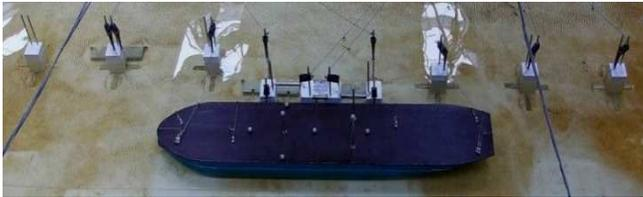
Figura 4. Modelo físico do navio do tipo petroleiro amarrado à estrutura de acostagem e amarração (modelo simplificado).
