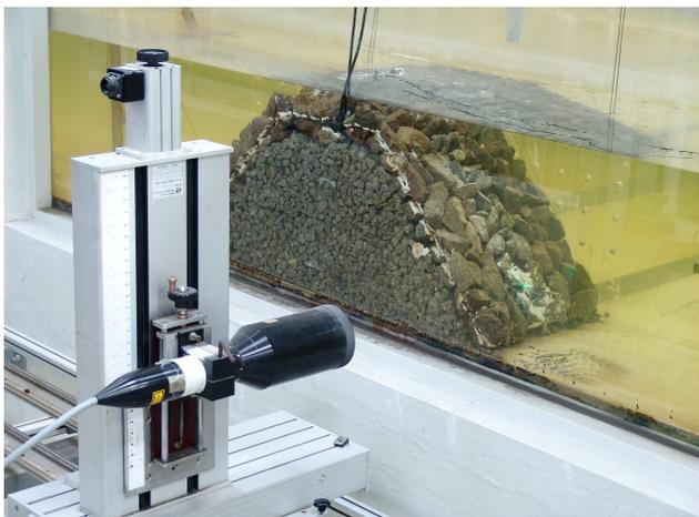
Figura 33. Mesa de coordenadas, sonda e módulos ópticos instalados.
