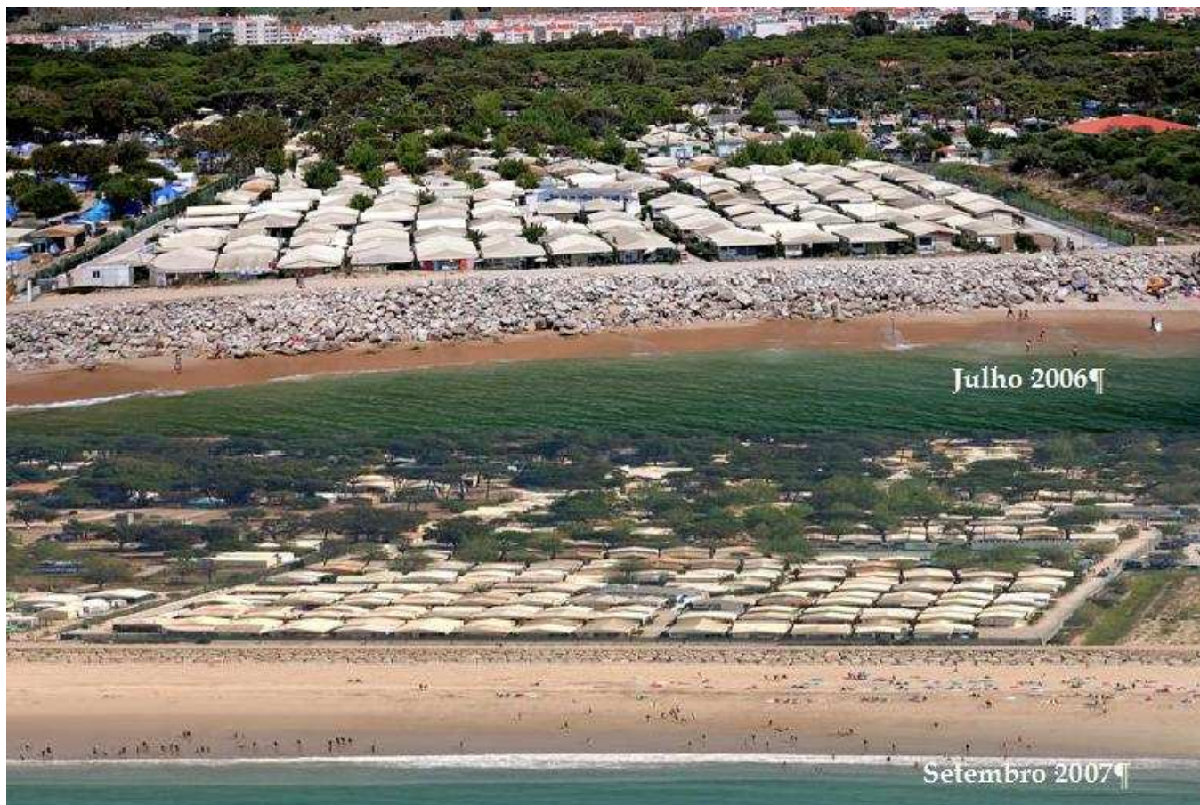
Figura 12. Situação na zona do parque de campismo, antes e após as intervenções (reperfilamento da obra aderente e alimentação artificial com areia).
