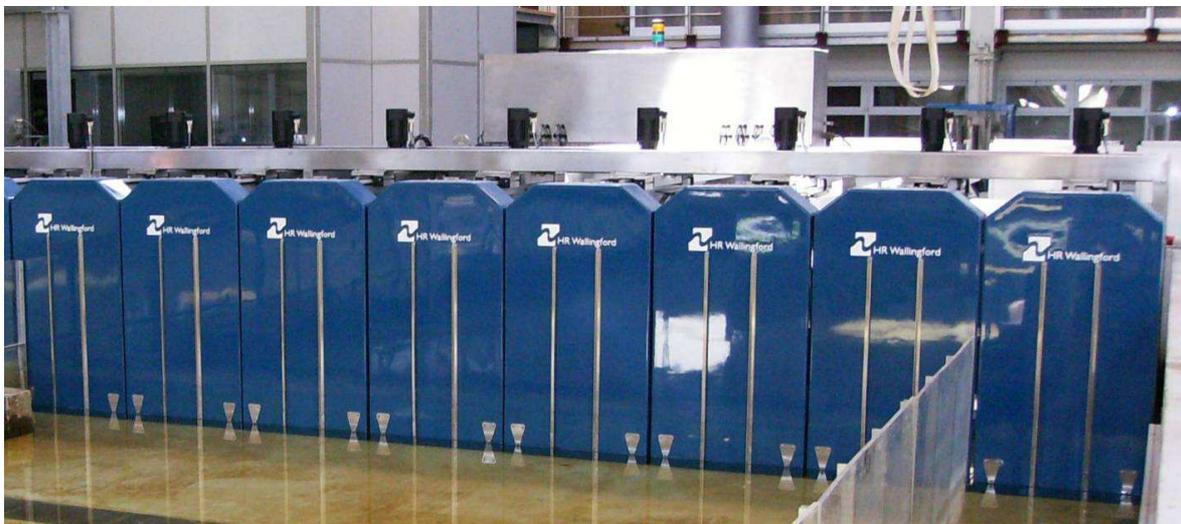
Figura 27. Módulo do gerador de agitação marítima, composto por oito pás de 75 cm cada, perfazendo uma largura de 6 m.
