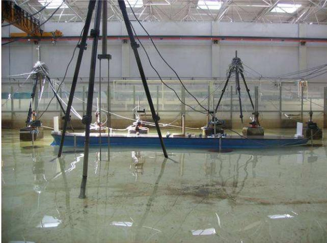
Figura 34. Instalação no tanque de ondas para a *Análise da Concepção e Dimensionamento de Dispositivos de Acostagem e Amarração em Pontes-Cais. Acções Hidrodinâmicas e de Impacto Específico*.
