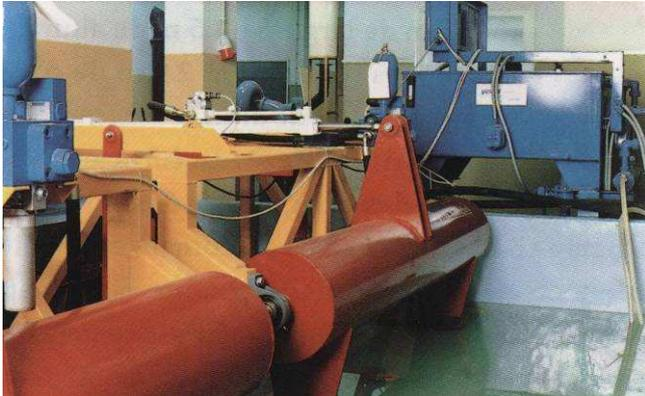
Figura 19. Batedores do tipo pistão, parte do sistema de geração de agitação marítima adquirido em 1992 (Ponto 3 na Figura 17) [Taveira-Pinto, 1995].
