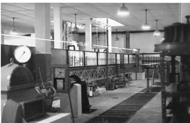
Figura 4. Canal de vidro de inclinação variável e turbina *Pelton* (Perspectiva 4 na Figura 1).
