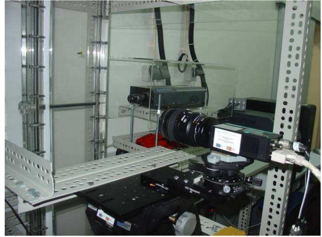
Figura 36. Equipamento para aplicação da técnica da Velocimetria por Processamento de Imagens de Partículas (PIV).
