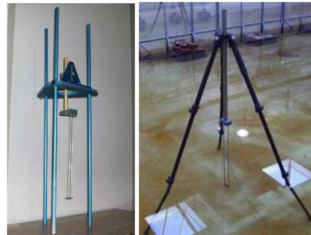
Figura 20. Sondas de níveis hidrodinâmicos existentes no Laboratório de Hidráulica em 1992 (esquerda) e mais recentemente (direita).
