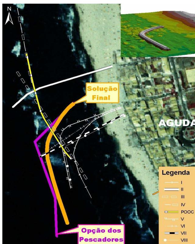
Figura 3. Sobreposição das várias opções consideradas e modelo 3D do quebramar destacado (solução final).
