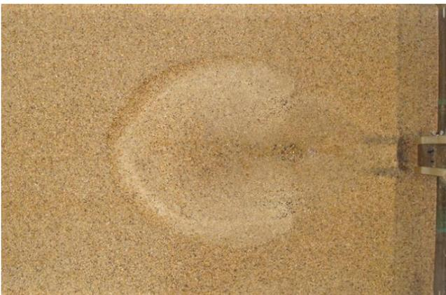
Figura 4. Cavidade de erosão sem realimentação, obtida para  $\alpha=20^\circ$ ,  $Q=0,71$  L/s e  $h=3$  cm (Machado, 2016).
