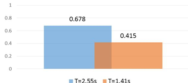
Figura 13. Comparação dos coeficientes de reflexão obtidos para o quebramar LOWREB, considerando dois períodos de onda diferentes, mantendo as restantes condições de simulação, isto é, nível de preia-mar para  $H=0.11m$  e  $k - \epsilon$ .
