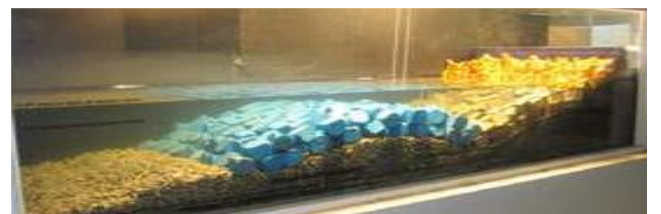
Figura 11. Modelo do quebra-mar norte do porto de Leixões com o quebra-mar submerso adjacente (FEUP).
