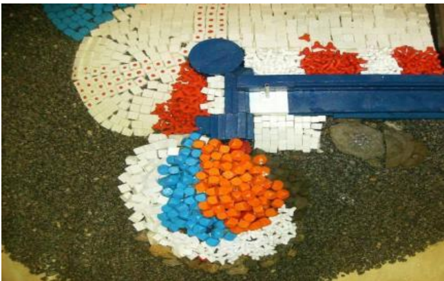
Figura 10. Ensaio em laboratório do comportamento de sistemas de confinamento de areias com geossintéticos. Dinâmica de fundos móveis na presença de geocontentores e de geocilindros (FEUP).
