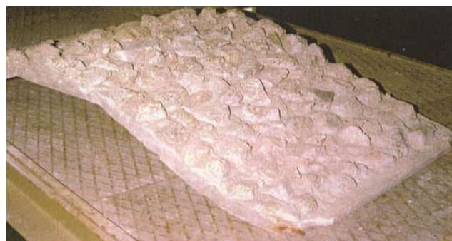
Figura 5. Modelo de estrutura com talude, com paramento exposto rugoso e impermeável (FEUP).
