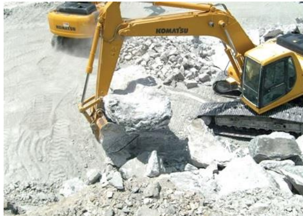
Figura 8. Processo de extração do gipso
