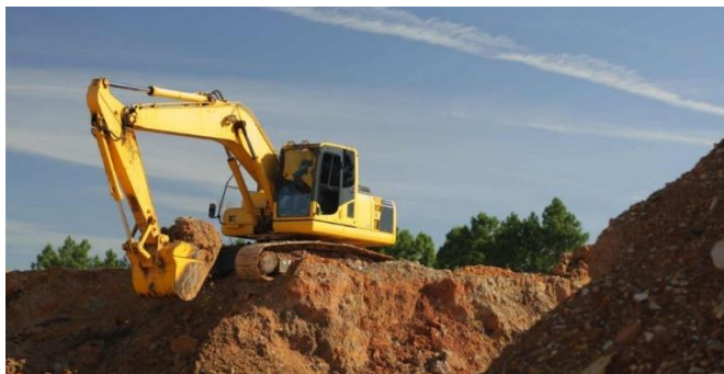
Figura 5. Extração mecânica de argila
