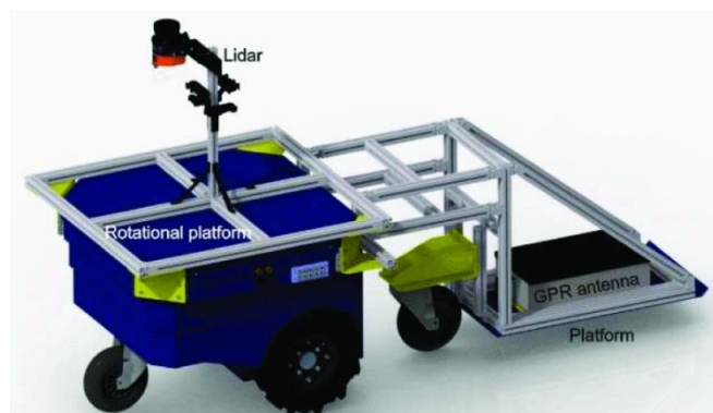
Figura 12 - Robô móvel e adaptado ao ambiente agrícola (Camps, A, C. López-Martínez, A. Gonga, G Gracia, A. Perez-Portero, A. Alonso-Gonzalez, M. Vall-Llossera. 2021)
