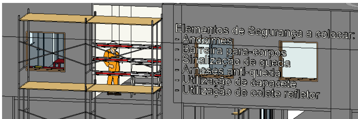
Figura 3.4 - Aplicação de um modelo BIM em prol da segurança
