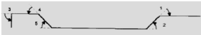
Figura 7 – Exemplo de sequência de dobragem (Navon, Rubinovitz, and Coffler 1995).
