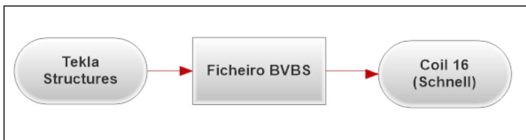
Figura 48 - Fluxograma do processo CAD/CAM com utilização do programa Tekla.
