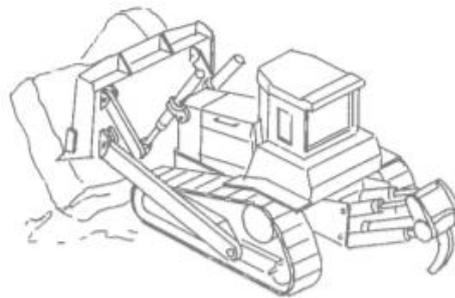
Figura 5 - Demolição por empuxe [7]
