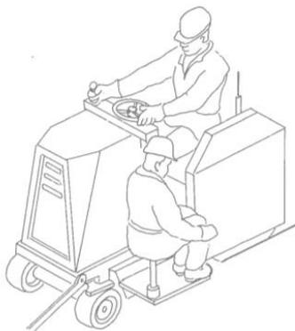
Figura 14 - Disco diamantado sobre rodas [7]
