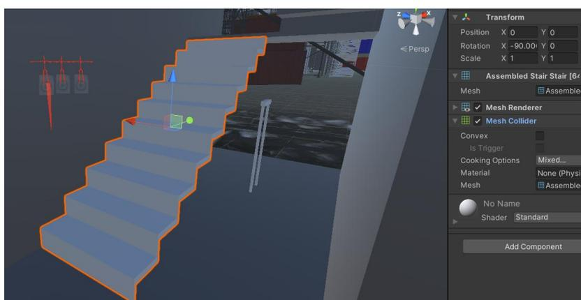
Figura 42 - Exemplo de *Mesh Collider* utilizado [captura de tela no Unity 3D]
