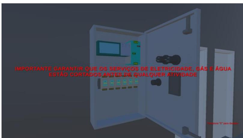
Figura 78 - vr\_building 1.0: Desligar do quadro elétrico (texto)
