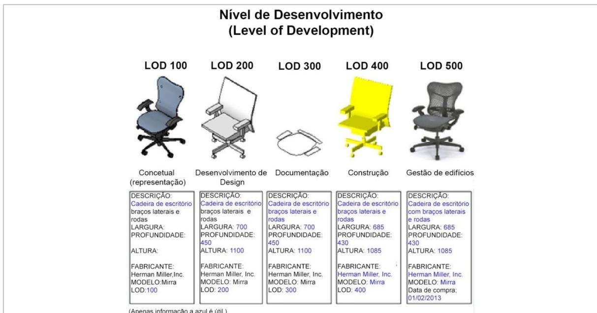
Fig. 2.7 – Representação de LOD, adaptado de [25]
