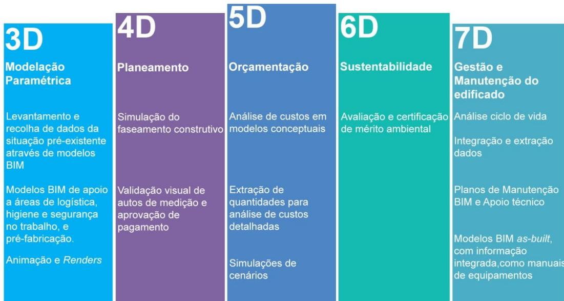
Fig. 2.3 – BIM 3D a 7D, adaptado de [20]
