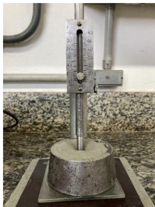
Figura 5. Ensaio de consistência normal da pasta com o auxílio do aparelho de Vicat.
