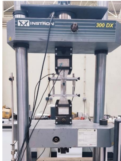
Figura 8. Instalação experimental para ensaio de tração uniaxial.
