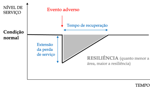
Figura 5. Resiliência estrutural de pontes
