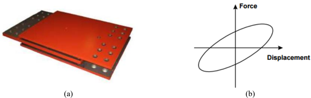
Figura 5. Amortecedor viscoelástico: (a) VED típico (b) Curva histerética de um VED.
