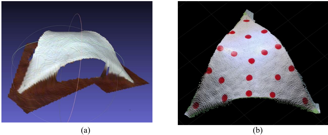
Figura 4. Modelo de nuvem de pontos 3D do modelo ABS de escala reduzida.
