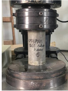
Figura 7. Aparato e corpo de prova durante ensaio de determinação de resistência à compressão axial.
