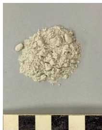
a) Fotografia do pó de vidro (escala: 1 quadrado igual a 1cm)
