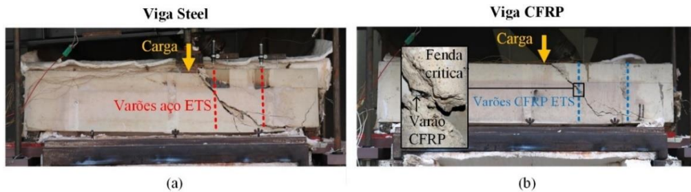
Figura 5. Observações pós-fogo das vigas ensaiadas: (a) Steel (b) CFRP.
