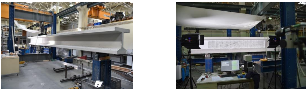
Figura 4. Ensaios de corte em vigas HPFRC simplesmente apoiada
