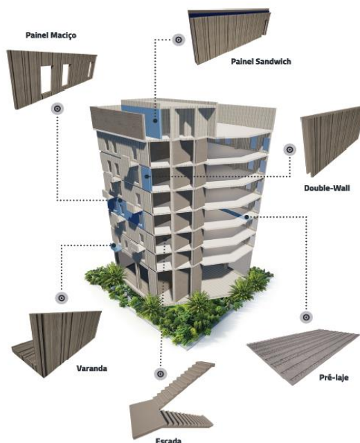
Figura 5. Estrutura de edifício constituído integralmente por elementos pré-fabricados em betão.
