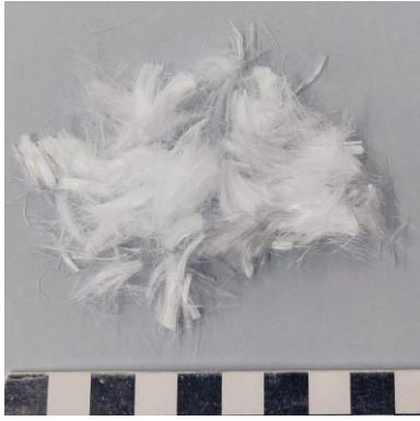
a) Fotografia das fibras PE (escala: 1 quadrado igual a 1cm)
