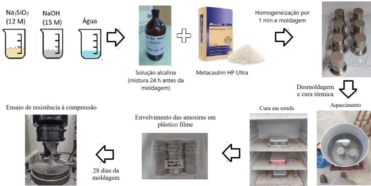
Figura 1. Esquema para produção das pastas.
