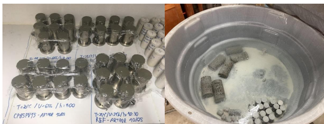
Figura 3. (a) Corpos de prova na câmara seca no período inicial de cura; (b) corpos de prova imersos no tanque de cura.
