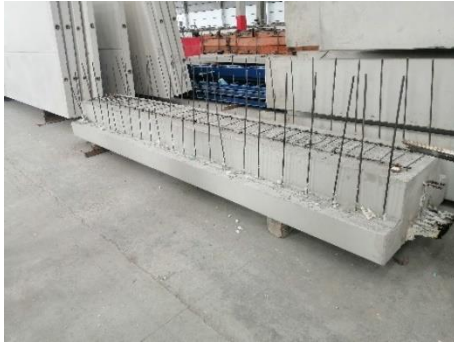
Figura 9. Viga Pré-fabricada em estaleiro.
